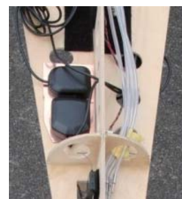
図2-1 オオワシ1号機に搭載された GPS/INS センサーと GPS アンテナ
