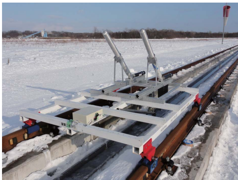
図1 フルサイズ高速走行軌道に設置した走行スレッド装置
