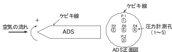
図 4 : ADS 先端部分の模式図
