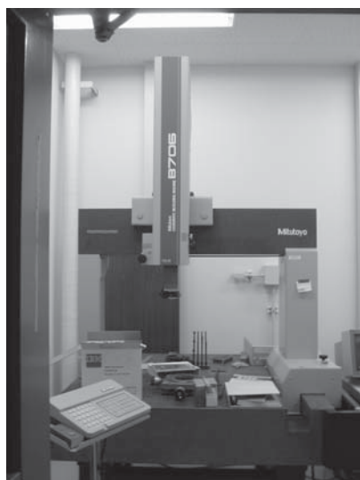
図3：室蘭工大で保有している三次元測定機(ミットヨ B-706 型)
