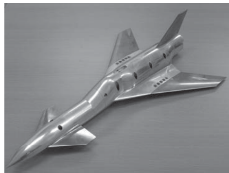
(b) 超音速飛行形態(KH,主翼前縁後退角56 deg.)
