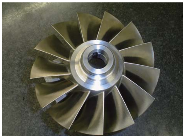
Fig.5 試作した反転軸流ファンの第一段ブリスク
