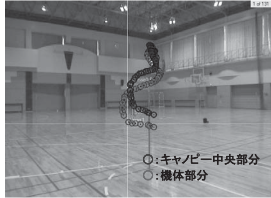
図4：パラfoil飛行経路の映像の解析例
