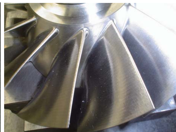
Fig.5 試作した反転軸流ファンの第一段ブリスク
