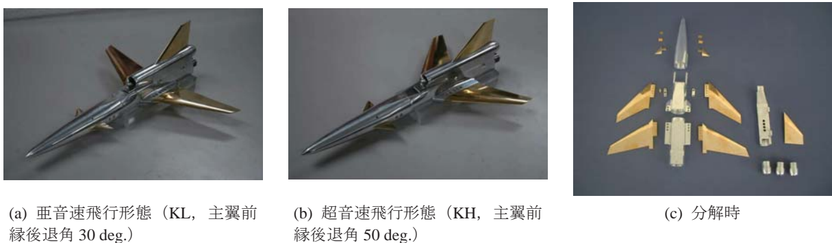
図 4 K 型機体 (可変後退角翼式機体) の供試体模型 (スケール 1/10)。
