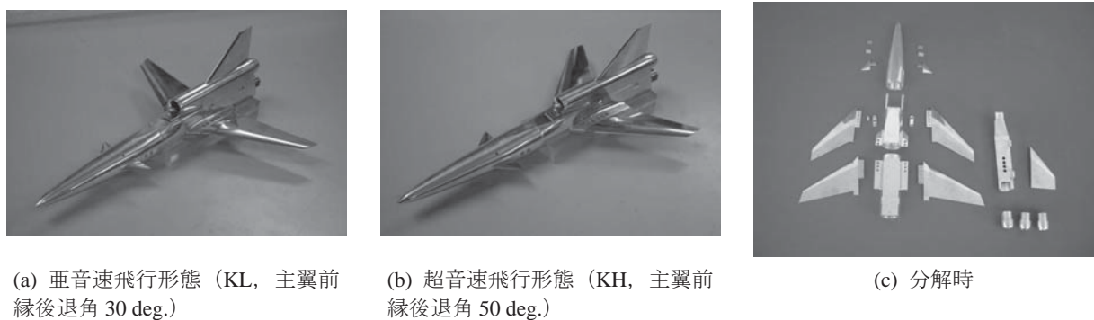
図3 K型機体(可変後退角翼式機体)の供試体模型(スケール1/10)。
