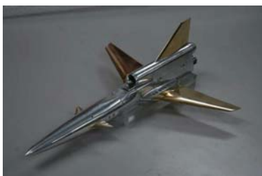
(a) 亜音速飛行形態 (KL, 主翼前縁後退角 30 deg.)
