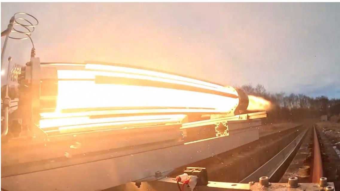
燃焼中の5kN級ハイブリッドロケット（2本クラスター運用）
