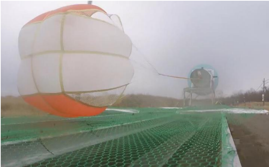
カプセル後方でのシュート開傘の様子（機上カメラにて撮影）
