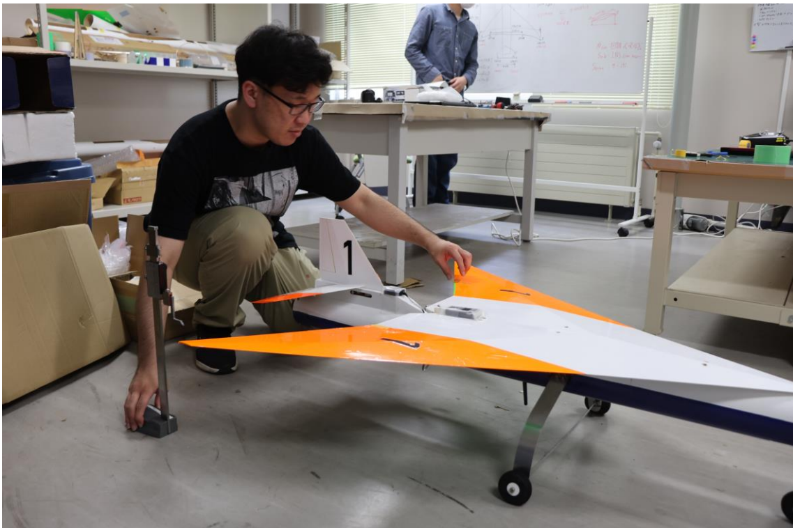
主翼取り付け精度の最終チェック
