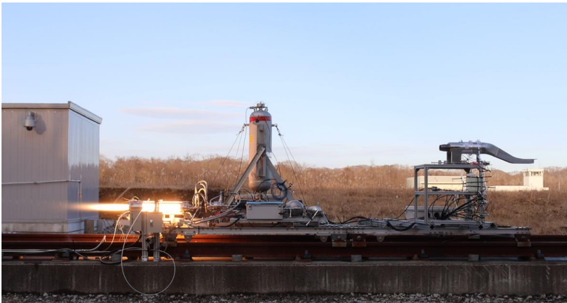
ロケットスレッドに搭載したインテークモデルと小型ジェットエンジン（右端）
