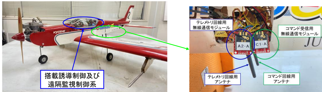
図3 搭載誘導制御及び遠隔監視制御系における無線通信モジュール
