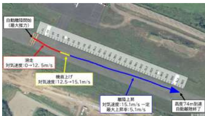
図2 固定翼 UAV 離陸プロフィール
