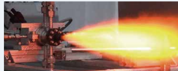
衛星用スラスタ等への適用を目指したカーボン製燃焼器の長時間耐久性試験（中田）
