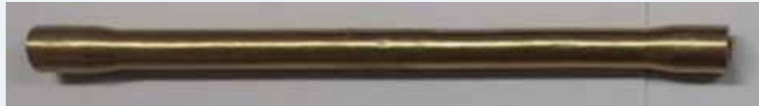
Cu-Al-Ni系単結晶形状記憶合金（SCSMA）
