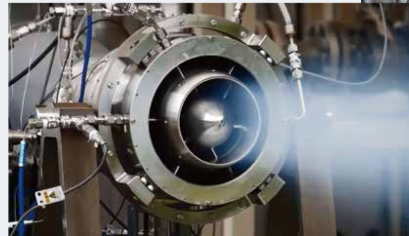
圧縮機とタービンの性能を調べるコールドフローテスト
