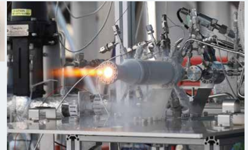
タービン駆動ガスを供給するガスジェネレーター
