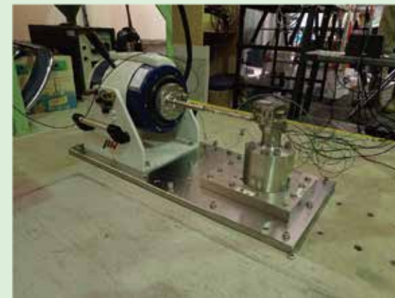
ジェットエンジン用軸受けダンパの振動試験
