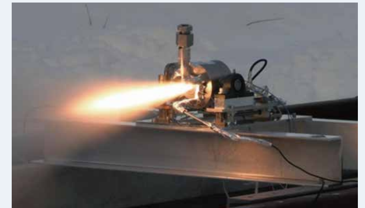
レーザー着火式固体ロケットエンジンの開発（江口・中田、JAXA・民間企業との共同研究）
