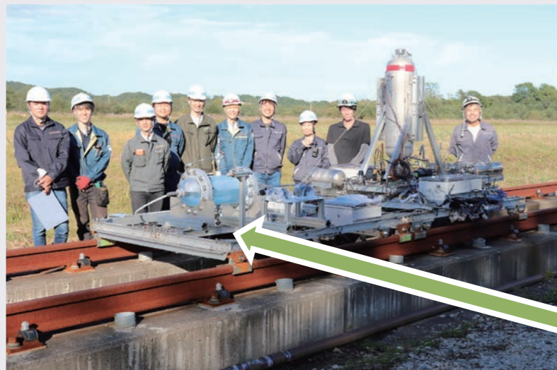
ロケットスレッドを用いた加速環境下でのスロッシング抑制効果実証実験
