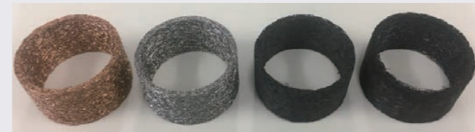
軸系を支える様々な材料のワイヤメッシュダンパー
