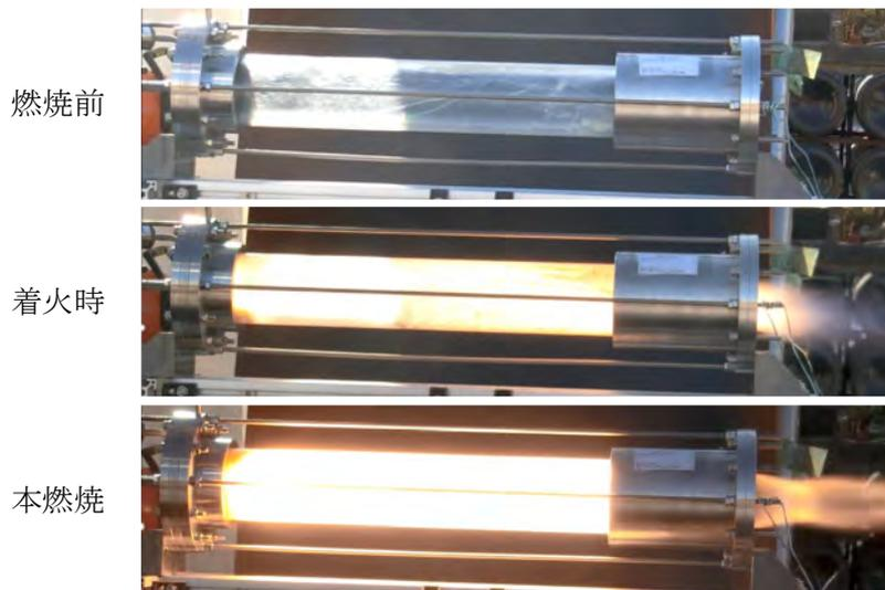
図9 燃焼試験の様子（上：燃焼前，中：着火，下：本燃焼）
