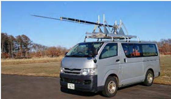
図3 車載走行試験による空気流傾斜角の計測
