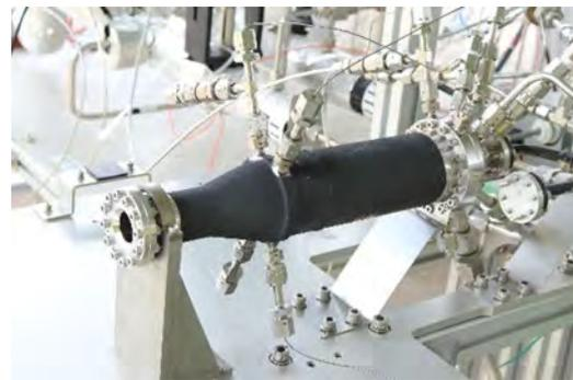
Fig. 3 塗装後の燃焼器概観
