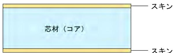
図1 主翼構造としてのサンドイッチ構造
