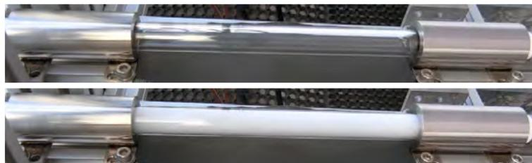
図6  $N_2O$  流し試験の様子（上：供給前，下：供給中）
