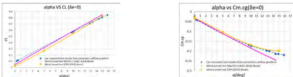
図6 空気流傾斜角実測値を用いた走行試験データの補正
