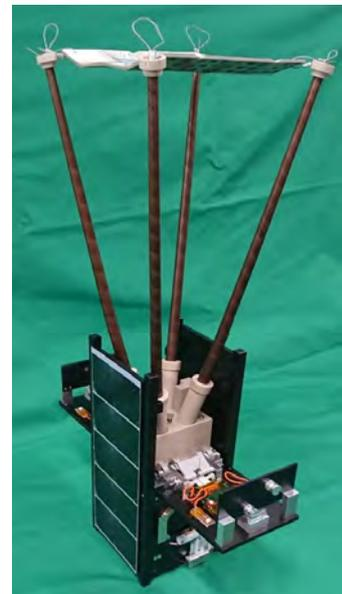
図2 超小型人工衛星「ひろがり」プレフライトモデル
