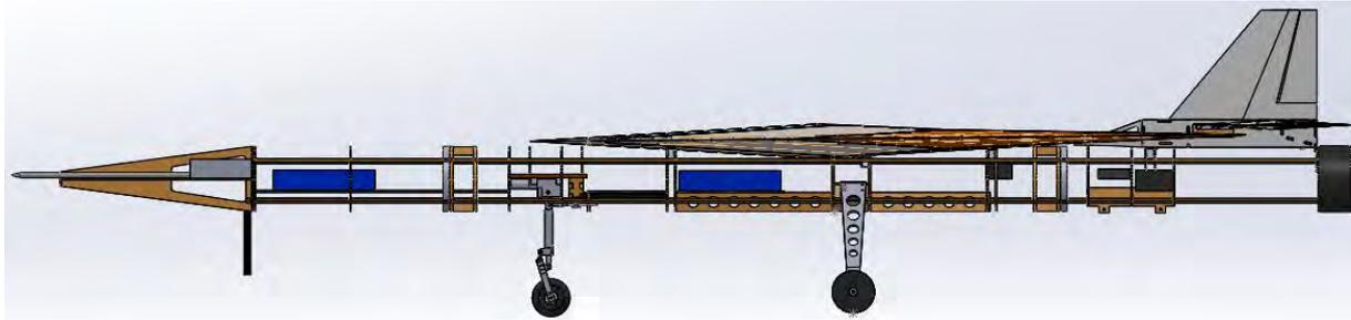
図6 胴体の改良構造
