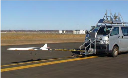
図7 縮小機体及び地面効果計測用櫓を乗用車に搭載した様子
