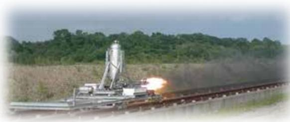
レール上の台車をロケットで加速するロケットスレッド(全長300m、最高速400km/h、加速度10G)は全国でもここだけのユニークな設備で、パラシュート試験や高加速度実証試験など、様々な用途に用いられています。構造設計や運用は本学の学生が協力して実施しており、システム工学の実践教材としても活用されています。
