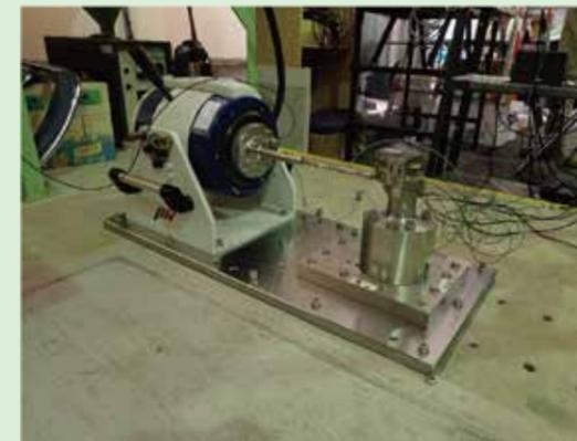
ジェットエンジン用軸受けダンパの振動試験
