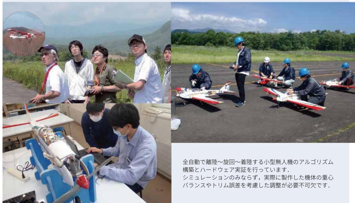
全自動で離陸～旋回～着陸する小型無人機のアルゴリズム構築とハードウェア実証を行っています。シミュレーションのみならず、実際に製作した機体の重心バランスやトリム誤差を考慮した調整が必要不可欠です。
