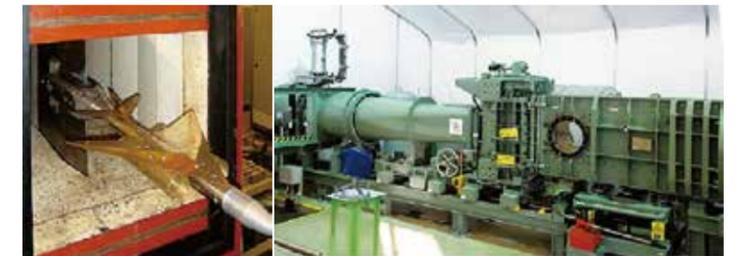
小型超音速無人機の空力計測試験
