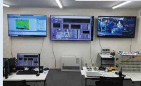
エンジンテストスタンドやロケットスレッド設備は100m離れた計測制御棟(2021年新設)と光ファイバでつなぐられ、安全に運用されます。
