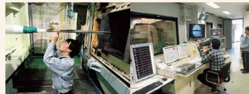
JAXA/ISAS遷音速風洞での風洞試験
